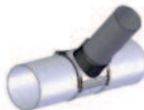
Colocar la nueva conduccion
