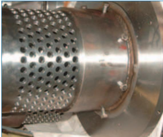
Dispositivo separado de estrangulación para instalación dentro de la tubería para reducción adicional de la presión.
