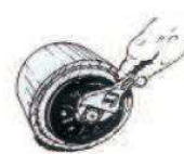
3 Apretar el tornillo 3/4 de vuelta con una llave.
