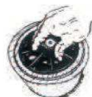
2 Inserte el cono rígido dentro de la articulación y gire el tornillo
