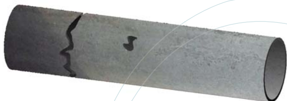
Grieta, rotura o pared deteriorada
