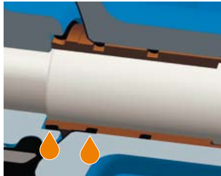
La protección anticorrosiva optimizada en el detalle a través de la obturación del árbol con revestimiento preciso permite una construcción sin contacto con el medio.
