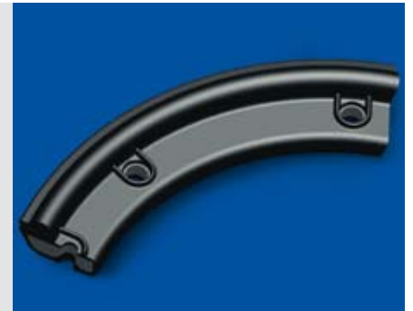
El anillo afianzador está completamente integrado en la envoltura elastomérica y no tiene contacto alguno con el medio. Las perforaciones están encerradas con faldas obturadoras y protegen así las perforaciones ros-cadas de la corrosión
