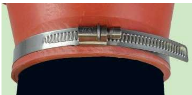
4 abrazaderas de acero inoxidable de 20 mm de ancho para tubos con un diámetro exterior desde 75 mm a 280 mm, par de apriete de 10 Nm
