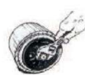
3 Apretar el tornillo 3/4 de vuelta con una llave.
