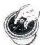
2 Inserte el cono rígido dentro de la articulación y gire el tornillo
