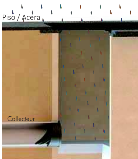
1. Un flujo muy bajo permite la evacuación a través de la CLAPETA anti olor.
