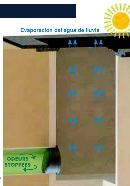
Clapeta cerrada : Los malos olores se quedan en el colector
